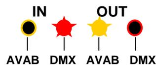
*En cas de rupture d'un signal, les 2 leds qui étaient allumées se mettent à clignoter, jusqu'à rétablissement de celui-ci. La réinitialisation du système se fait en débranchant et rebranchant le boîtier.*
